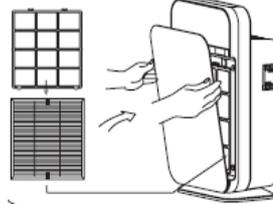
4. Setzen Sie das Filterelement mit Blick auf den Baumwollfilter (blau, schwarz oder grün) wieder ein und befestigen Sie die Frontplatte.
