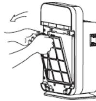
2. Drücken Sie die beiden Befestigungen des Vorfilters herunter und entnehmen das Vorfilter.
