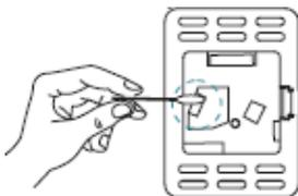
Der Sensor für die Luftqualitätsmessung sollte etwa alle 3-6 Wochen gereinigt werden. Nehmen Sie dazu vorsichtig die Abdeckung ab und reinigen Sie den Sensor mit einem mit reinem Wasser befeuchteten Wattestäbchen. Bitte keinen Alkohol oder sonstige Reinigungssubstanzen verwenden, da der Sensor sonst Schaden nimmt.
