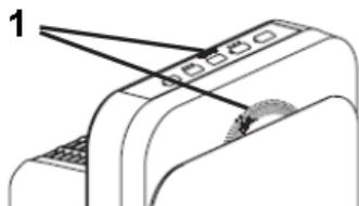
1. Der Luftreiniger misst über einen intelligenten Staubsensor die Luftgüte und zeigt diese farblich an:
