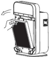
3. Nehmen Sie die Filtereinheit aus dem Gerät und entpacken Sie diese aus der Schutzfolie.
