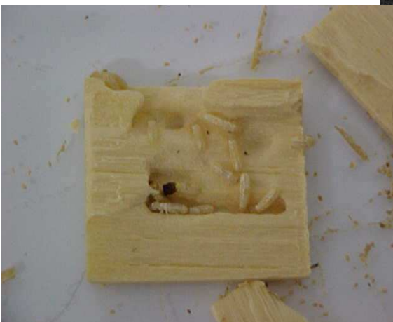
Abbildung 3: Termiten in den zersplitterten Testproben auf der Platte
